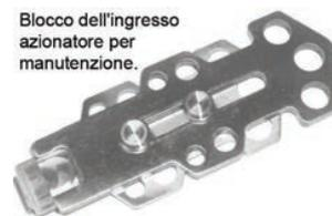
Dispositivo per bloccare la macchina fuori servizio: si inserisce nell'interruttore e lo blocca in posizione aperta nel corso delle operazioni di manutenzione. Offre più posizioni per l'applicazione dei lucchetti.
