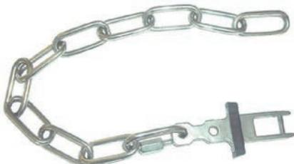
Un azionatore piatto fornito con una catena lunga 300mm (12"). Si può utilizzare dove vi sia scarso allineamento del riparo mobile con il riscontro fisso. L'inserimento dell'azionatore deve essere fatta manualmente. Costruito in acciaio inossidabile
