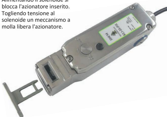
**Interruttore di sicurezza con solenoide per il bloccaggio del riparo con forza di chiusura fino a 3000N (300kg) (F1 Max).** Gli interruttori di sicurezza con solenoide per il bloccaggio dei ripari tipo KL3-SS-P2L hanno il corpo in acciaio inossidabile AISI 316; sono in grado di esercitare una forza di tenuta F1 di 3000N così da mantenere bloccati i ripari mobili di medie e grandi dimensioni, fino alla rimozione del pericolo all'interno della macchina.
