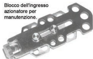
Dispositivo per il blocco fuori servizio della macchina: Si inserisce nell'interruttore e lo blocca in posizione aperta nel corso delle operazioni di manutenzione. Offre più posizioni per l'applicazione dei lucchetti.
