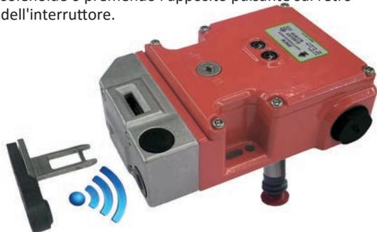
**Interruttore di sicurezza con solenoide per il bloccaggio del riparo con forza di chiusura di 3000N (300kg) (F1 Max) e dispositivo per il rilascio manuale di emergenza sulla parte posteriore.**
