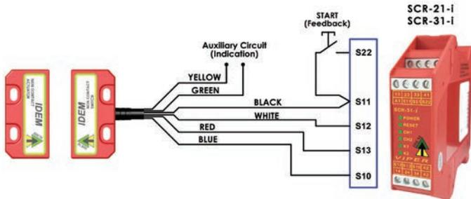
Interruttore singolo collegato ad un SCR-21-i o ad un SCR-31-i per il controllo a due canali di un riparo mobile e riarmo manuale. Il circuito di controllo (opzionale) segnala lo stato del riparo.
