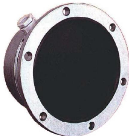
**Montaggio:** Il segnalatore si applica dall'esterno del contenitore, sulla parete verticale praticandovi un foro Ø 110 mm. Il pressacavo deve essere orientato verso il basso.
