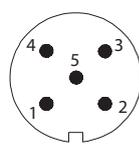
Pin lato saldatura
