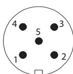
Pin lato saldatura
