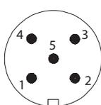
Pin lato saldatura
