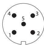
Pin lato saldatura
