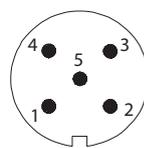
Pin lato saldatura
