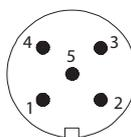
Pin lato saldatura
