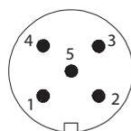
Pin lato saldatura
