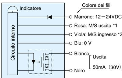
1\* aprire l'uscita Master/Slave (rosa) quando si utilizza il sensore singolarmente. Quando il sensore è l'ultimo Slave in un collegamento M/S cortocircuitare l'uscita a 0V.
