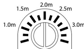
Nota: se nell'area di rilevamento esiste un oggetto sullo sfondo, assicurarsi di regolare la distanza ad un punto di almeno 0.75m di fronte a quello sfondo. Inoltre, la scala della distanza è solo indicativa e non ne assicura la precisione.
