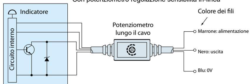
L'emettitore della versione a sbarramento è fornito solo di alimentazione (marrone: 12~24 VDC; blu: 0 V).
