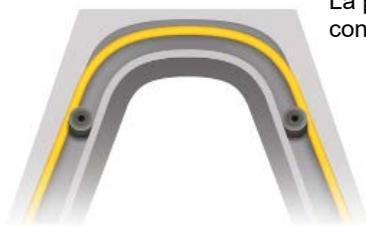
La posizione del loop viene rilevata controllando la velocità
