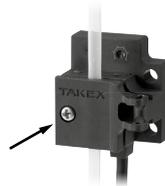
Bloccare il tubo con il coperchio e fissarlo con la vite.
