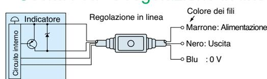
\*L'emettitore della versione a sbarramento è provvisto solo di alimentazione (marrone: 24 VDC; blu: 0 V).
