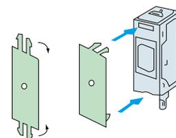
Piegare manualmente i piedini ed inserirli nelle fessure apposite del sensore
