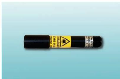
Puntatore laser costituito da un diodo laser a luce rossa di elevata qualità, disponibile nella lunghezza d'onda di 635 nm e con una potenza di 3mW. La ghiera permette una facile regolazione del fuoco.
