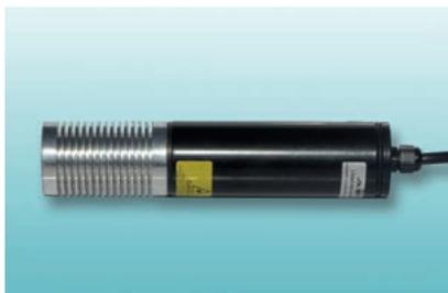
Puntatore laser a luce rossa disponibile nella lunghezza d'onda di 650 nm e con una potenza di 50mW che può generare una linea. La custodia ermetica rende questo puntatore particolarmente adatto a lavorare in ambienti con presenza di acqua (per es. nel settore del marmo) ma è particolarmente adatto per allineamenti nei carriponte.
