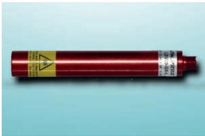
Puntatore laser costituito da un diodo laser a luce verde di elevata qualità disponibile nella lunghezza d'onda di 520nm e con una potenza di 1mW. Il diodo genera un punto, una linea oppure una croce. La custodia in alluminio anodizzato e il vetro di protezione permettono al puntatore di lavorare in ambienti con presenza di acqua o ambienti gravosi. A richiesta altre potenze. A richiesta alimentazione 12...48 Vdc / 6...24 Vac.
