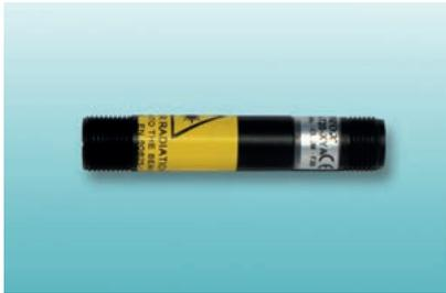
Puntatore laser costituito da un diodo laser a luce rossa di elevata qualità, disponibile nella lunghezza d'onda di 635 nm e con una potenza di 3mW. Custodia in alluminio.
