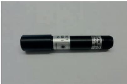
Puntatore laser costituito da un diodo laser a luce rossa di elevata qualità, disponibile nella lunghezza d'onda di 635 nm e con una potenza di 0.39mW. La regolazione del fuoco permette di ottenere un punto ben focalizzato fino ad un'altezza massima di 1 m dal piano di lavoro. Inoltre rientrando nella classe di sicurezza 1, anche la visione diretta del fascio non crea alcun danno all'occhio umano.
