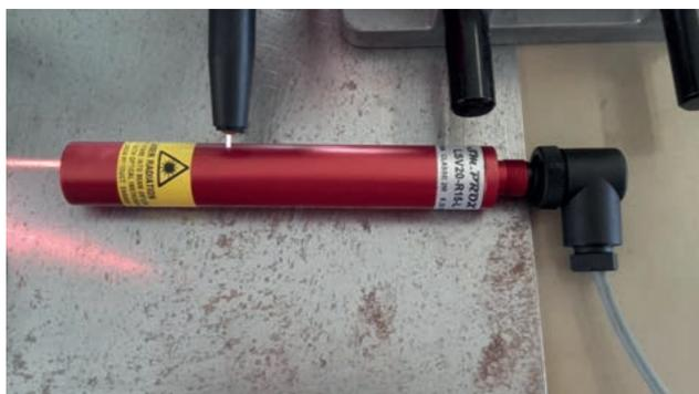
I puntatori laser Sm.Prox sono sempre più protetti dalle cariche elettrostatiche e dai disturbi infatti i nuovi puntatori hanno protezioni specifiche sul diodo laser.
